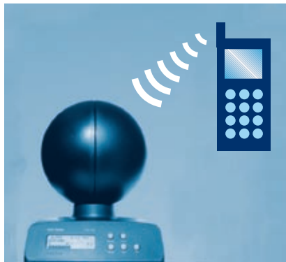
Abb. 7: Ermittlung der elektromagnetischen Felder durch einen SAR-Messkopf
